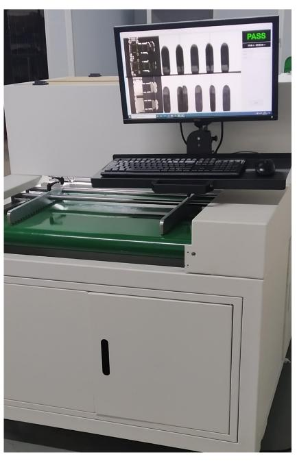
辰视PCB检测专用机可以在5秒内检测完成 250mm\*250mm的PCB板,检测完成后自动将好坏板 分区放置。
